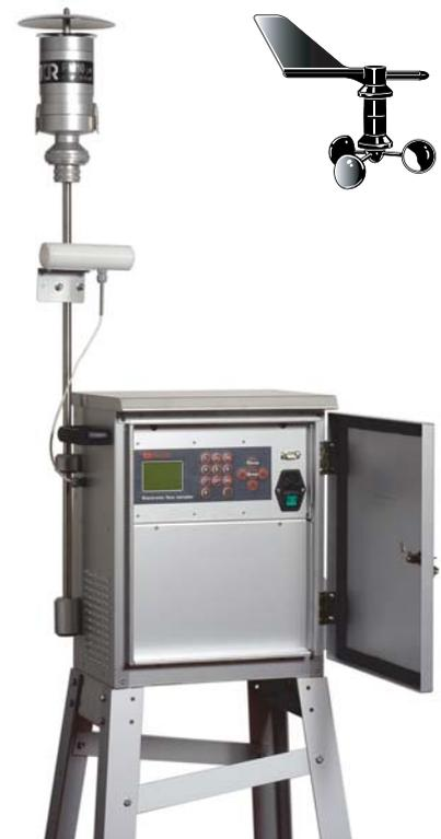
Corredato delle rispettive teste di campionamento ECHO PM può essere utilizzato anche nel rispetto delle norme di campionamento ISO/CD 16362 per la determinazione degli idrocarburi policiclici aromatici.
