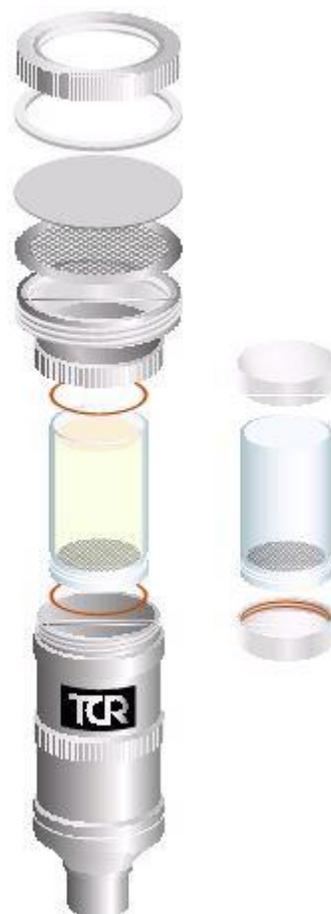
*Dettaglio modulo campionamento e cartuccia PUF con tappi*
