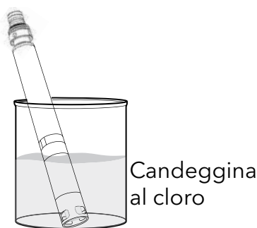
Figura 74 Pulizia del sensore pH e pH/ORP con candeggina al cloro
