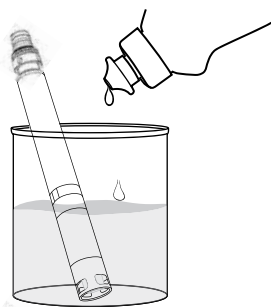
Figura 72 Pulizia del sensore pH e pH/ORP con sapone per i piatti
